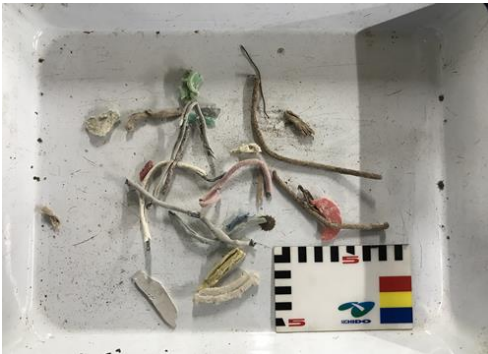
写真1 骨材 36t から取り出した混入物
