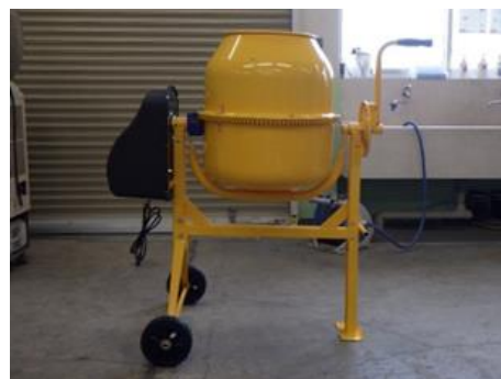
写真-2 モルタルミキサ外観
