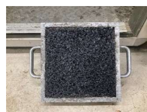
図-2 常温低速ホイールトラッキング
