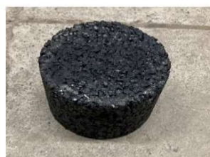
図-1 常温カンタプロ・常温マーシャル安定度
