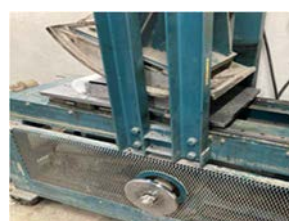
図-2 常温低速ホイールトラッキング
