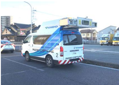
写真 1 路面性状測定車による測定状況
