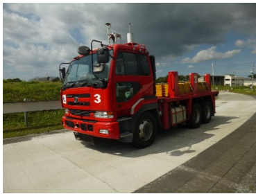
写真-2 荷重車による走行状況
