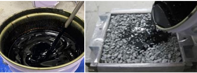
写真-1 特殊バインダ 写真-2 流し込み状況
