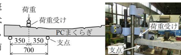
図 3 静的曲げ試験の概要（正曲げ試験）
