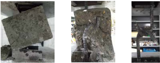
写真 2 hook-3 φ 載荷の様子 (左: ひび割れ開始, 中: かぶり剥落, 右: 完全に剥落)
