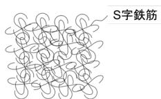
図 2 S 字鉄筋の引っ掛かり合い
