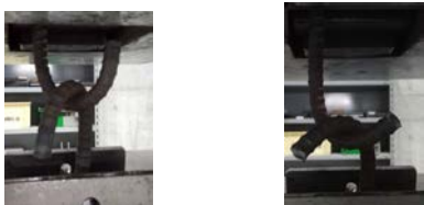
写真 1 hook-N 載荷の様子(左: 載荷前, 右: 載荷中)
