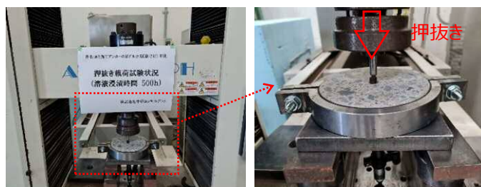
写真-2 押抜き試験状況
