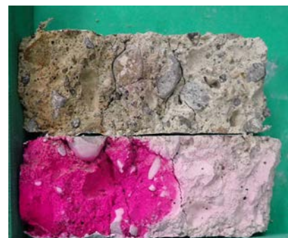
写真-1 浸漬後の試験体（CT桁、縦張側面）
