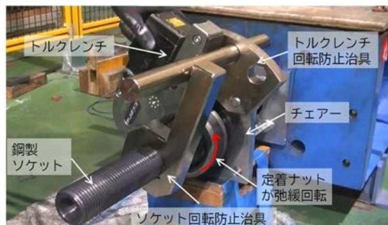
図 3 トルクレンチによる導入方法
