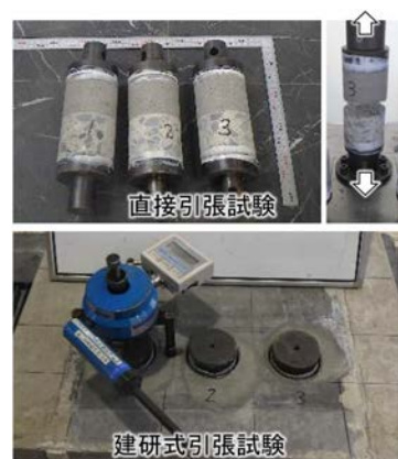
写真-1 付着強度試験
