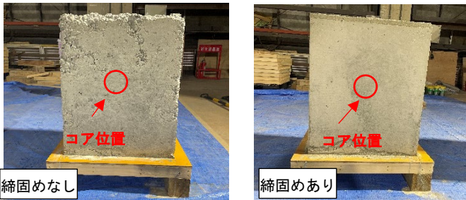
写真-1 脱型後の試験体の側面
