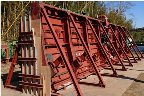
写真－1 模擬型枠
