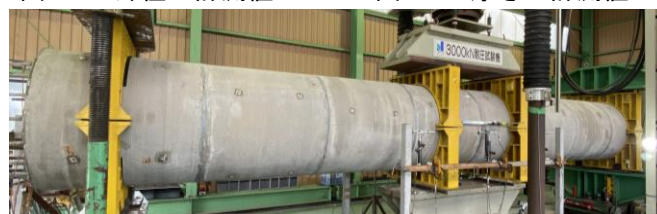
写真-8 載荷試験状況
