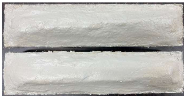
(a) 厚付型高炉スラグ混合セメント系防食材塗装系
