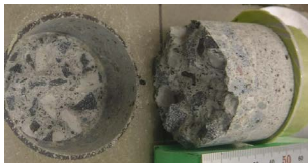
図-3 付着試験における破壊状況の一例
