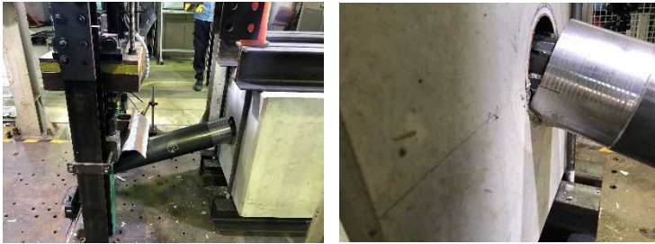
写真-5 ②支柱の試験後
