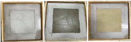
通常施工 セメントペースト塗布 微粒分敷き均し
