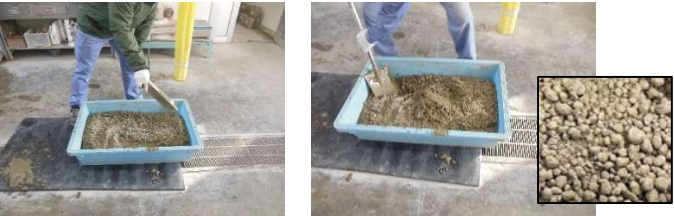
写真-1 粒状化再生骨材の製造状況
