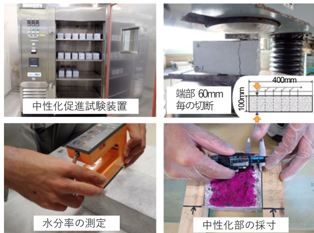
図3 促進中性化および評価試験状況
