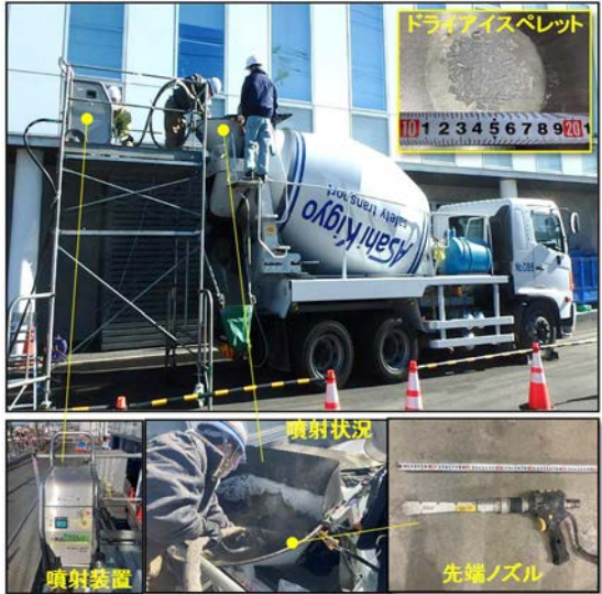
図-1 ドライアイス噴射状況
