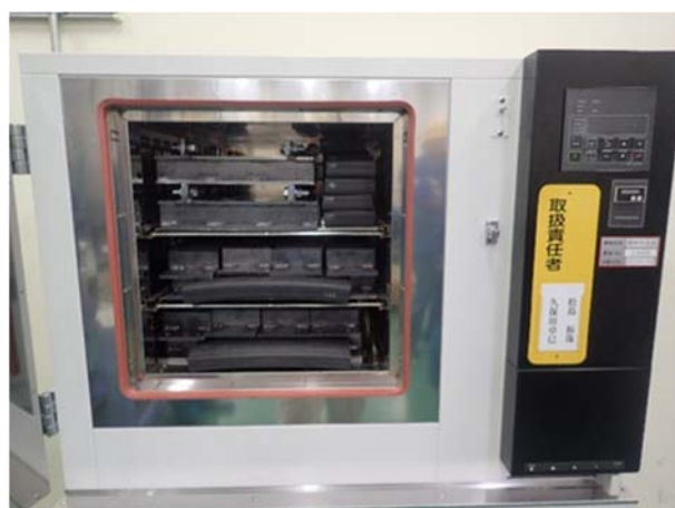
写真 2. 熱老化試験状況
