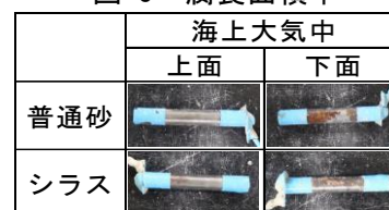
写真-1 横打ちの腐食
