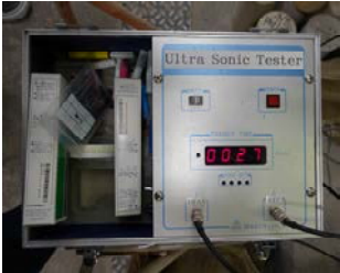
写真-1 超音波非破壊試験機
