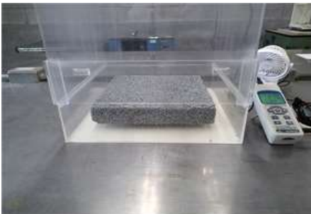
写真-2 ポーラスコンクリート版の測定
