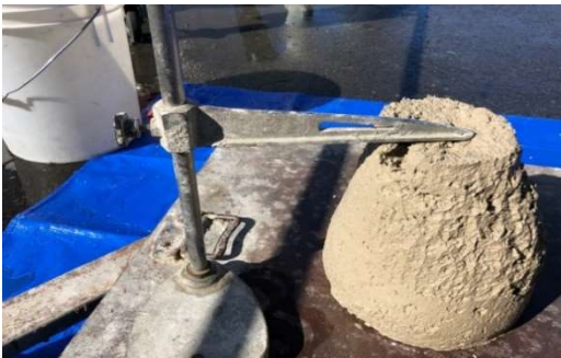
写真-1 スランプ試験状況(運搬後)
