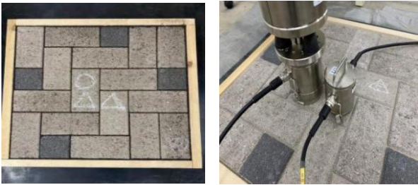
a) IL ブロック舗装 b) 小型 FWD 装置
