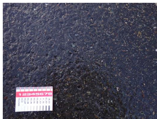
写真-1 氷膜路面（機能性 SMA、散布前）
