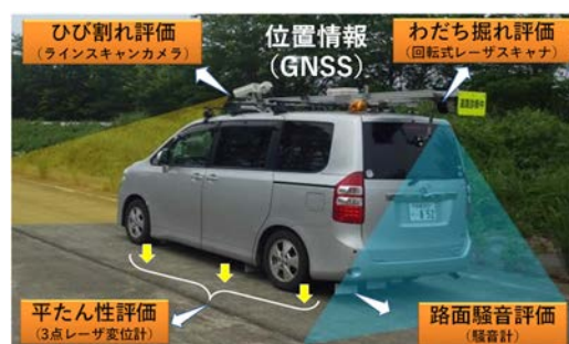
写真-1 多機能路面測定評価システムの概要 (NETIS 登録番号:SK-170013-VR)
