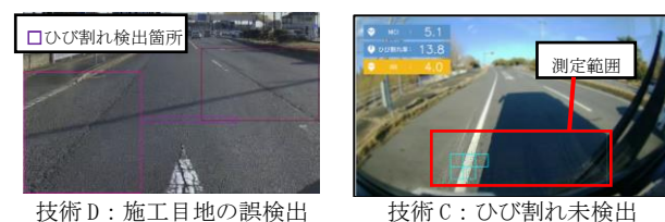
図6 ひび割れ率測定誤差の影響
