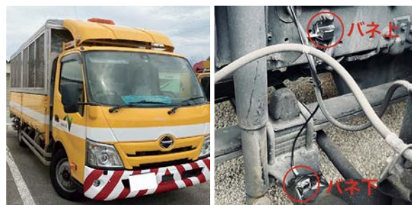
(a)車両外観 (b) 加速度計設置状況 図-3 走行試験車両
