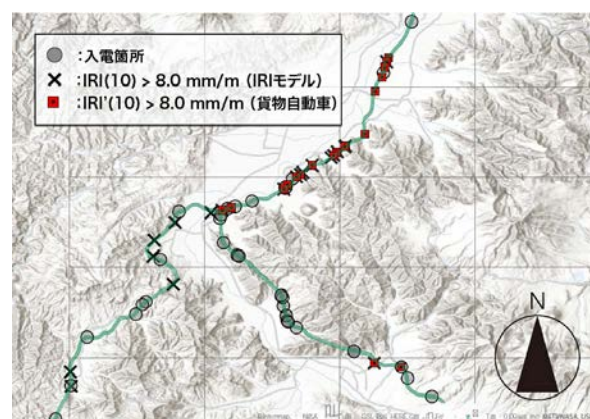
図-6 車両特性を考慮した平たん性評価結果
