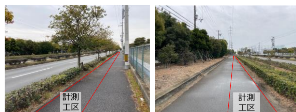
(a) ポーラス舗装 (b) 密粒度舗装
