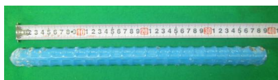
(a) 巻立て部の EP 筋 (軸方向鉄筋)
