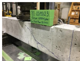
(c) ひび割れの様子
