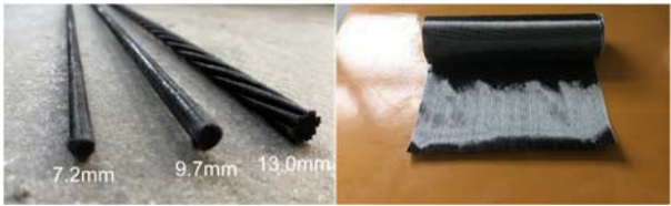
図-1 CFCCと炭素繊維シート
