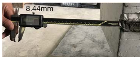
図-8 CFCC ( \phi 7.2\text{mm} ) の端部すべり
