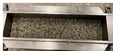
写真-2 洗出し表面（散布量 450\text{g/m}^2 ）
