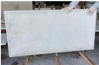
写真-1 埋設型枠
