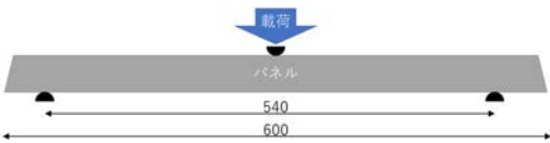
図-3 パネルの载荷方法（単位 mm）
