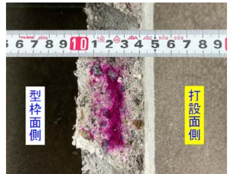
図－5 断面の炭酸化状況
