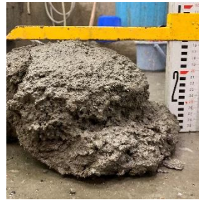
写真-10 吹付け厚 5 穴 W/C40
