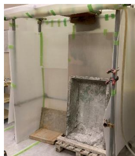
写真-1 吹付け試験装置
