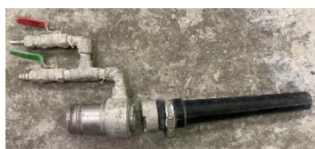
写真-3 ノズル・急結剤添加部
