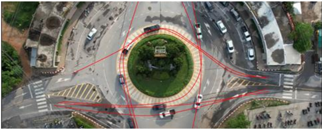
図ー 1 対象ラウンドアバウトでの走行軌跡の例
