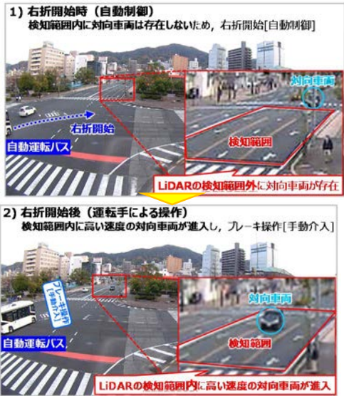
図6. 手動介入時①高い速度での進入・走行)の例
