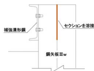
図-5 鋼矢板補強
