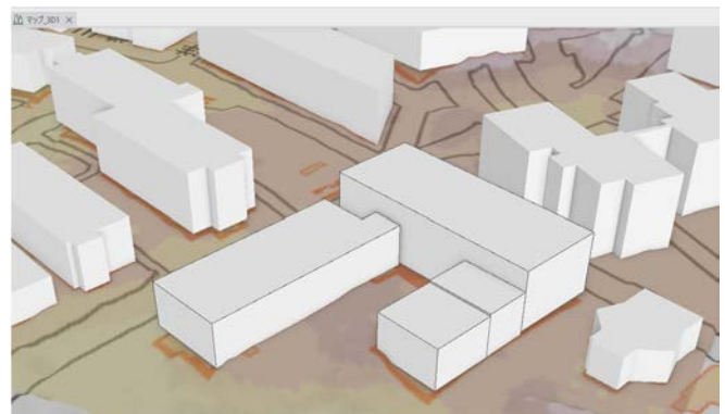
図-3 GISに展開してTSの実測値をもとに修正したモデル
