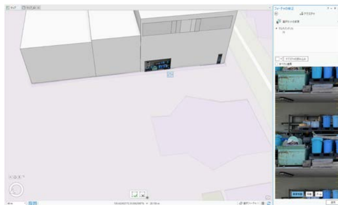
図-7 物置マルチパッチに歪み補正した側面写真を貼り付け
