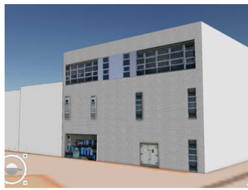
図-9 GIS による三次元建物モデルの側面写真の貼り付け
