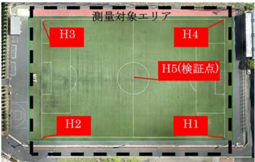
図-1 サッカーグラウンドおよび標定点
