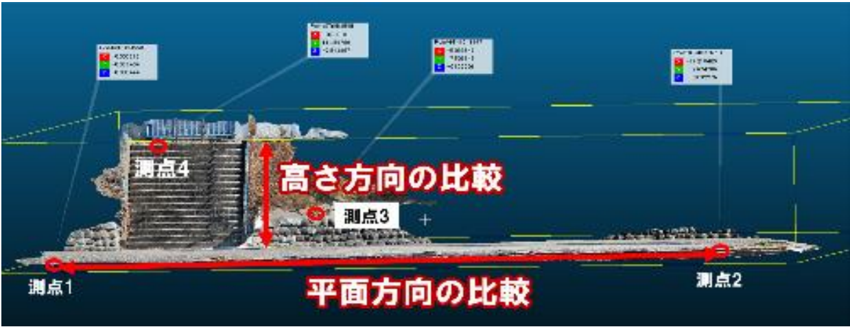
図-3 測定点の配置および精度検証の状況
