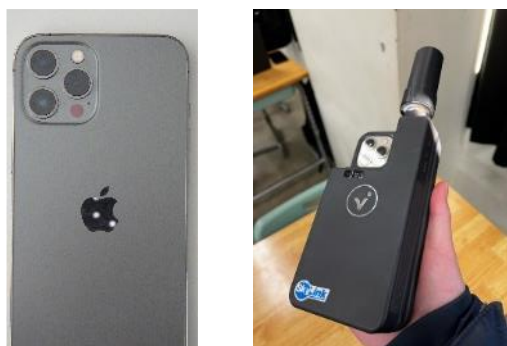
図-1 iPhone 12 Pro max の LiDAR センサーと viDoc を取り付けた iPhone
