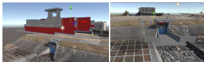
図-3 構造物モデル（樋門）の設置例
