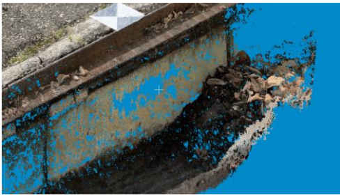
図-2 NeRF で計測した側溝内の堆積物
