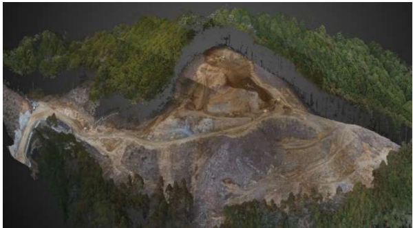
図-1 工事現場全域の 3D 点群データ
