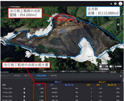
図-2 「Smart Construction Dashboard」土量管理画面
