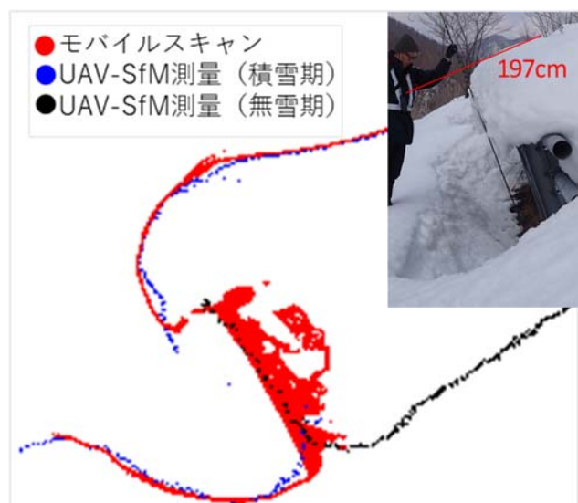
図-3 雪庇高さの比較 (A-A 断面)
